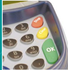
Tastatur mit ergonomischem Sichtschutz und taktilen Symbolen
